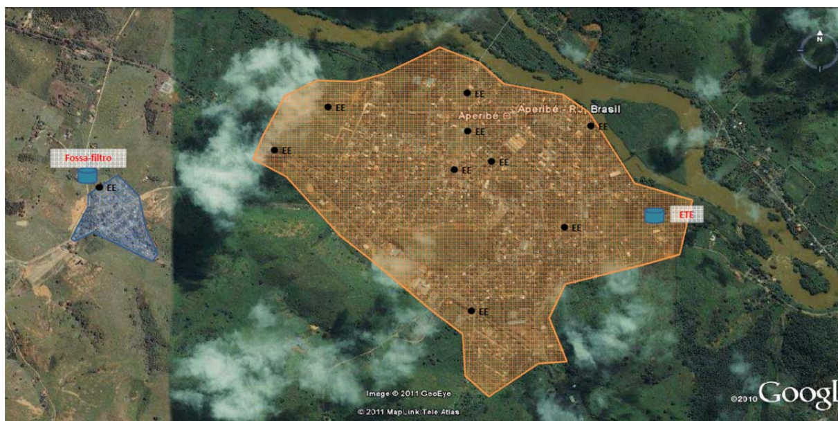
FIGURA 30 – ÁREA DE CONTRIBUIÇÃO DA ETE PROJETADA.
